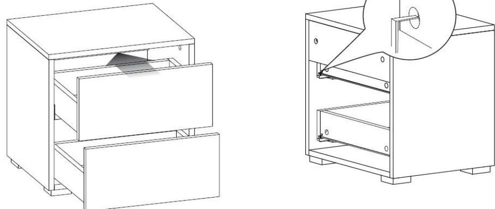
Выдвиньте подвижные элементы направляющих, вставьте ящик и задвиньте до щелчка. Крючки направляющих должны войти в зацепление с отверстиями в задней стенке ящика.
